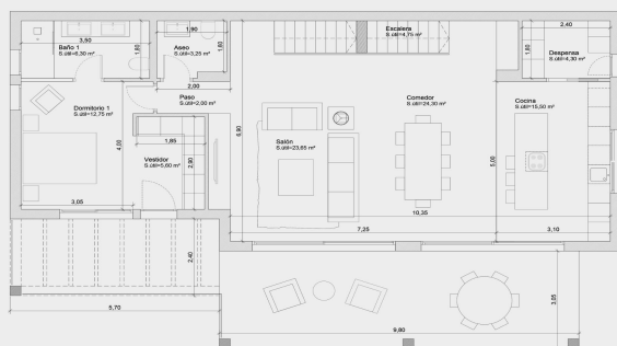
PLANTA BAJA Sup. construida vivienda 119,17 m² Sup. construida porche 29,90 m²
